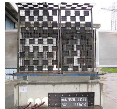
Störlichtbogenprüfung, Zugänglichkeitsgrad A für den Schutz von Bedienpersonal (Stationstüren geöffnet)
